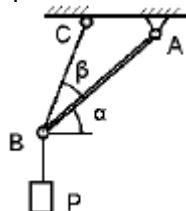
2. Груз весом  $P = 10 \text{ Н}$  подвешен на двух тросах AB и BC, составляющих с горизонтальной прямой углы  $\beta=15^\circ$  и  $\alpha=30^\circ$ . Определить усилия в тросах.
